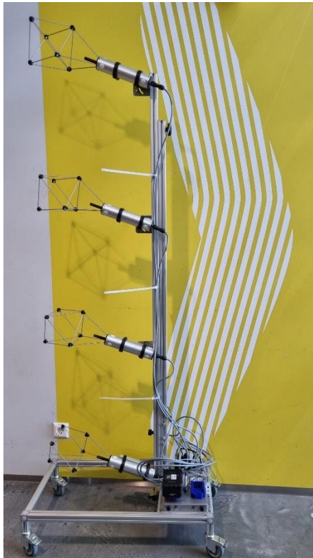
Figuur 2-3 - De mobiele meetstructuur met akoestische meetkoppen.
