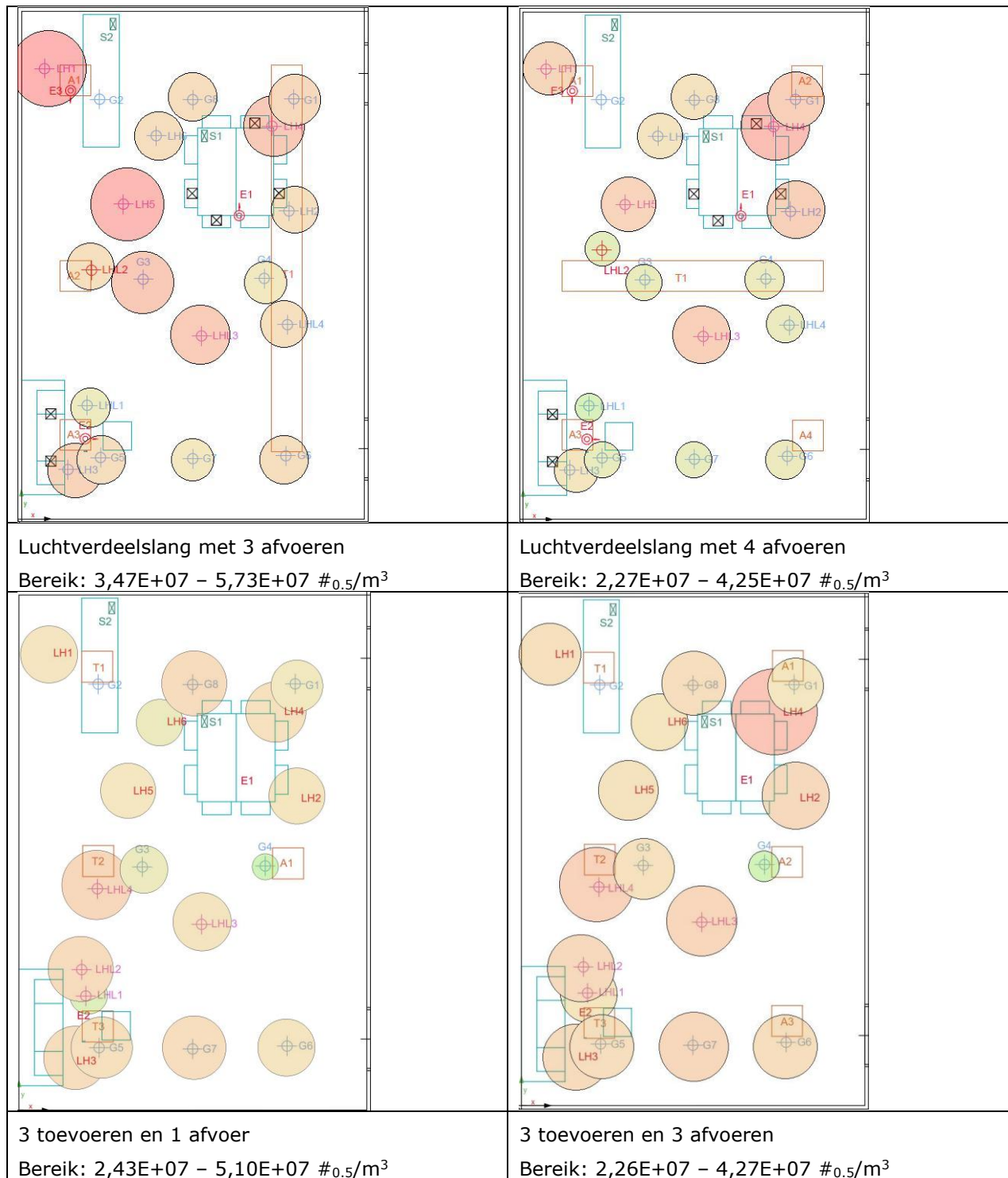
Figuur 3-5. Maximale deeltjesconcentratie op hoogte 1,2 m bij bronlocatie E1 voor vier verschillende ventilatieopstellingen in een langdurige zorgsetting.
