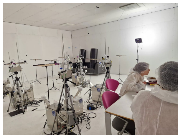
Figuur 4. Impressie van de metingen met vrijwilligers in de testfaciliteit. De zwarte kokers representeren additionele warmtebronnen.
