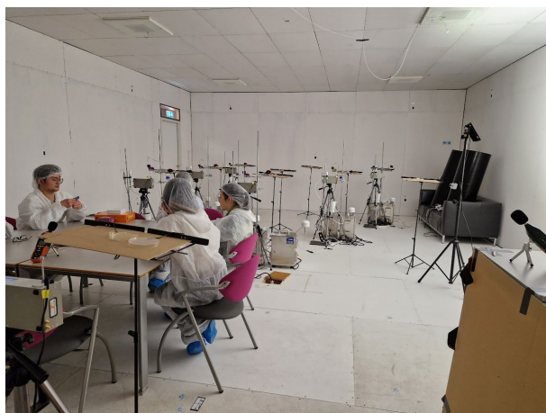
Figuur 4. Impressie van de metingen met vrijwilligers in de testfaciliteit. De zwarte kokers representeren additionele warmtebronnen.
