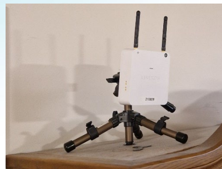
Figuur 3 Een ontvanger ('anchor') uitgerust op een statief
