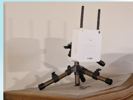
Figuur 4 Een ontvanger ('anchor') uitgerust op een statief
