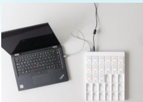
Figuur 3 Laptop en witte tray met draagbare sensoren ('tags')
