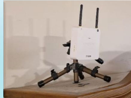
Figuur 3 Een ontvanger ('anchor') uitgerust op een statief
