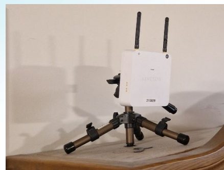
Figuur 4 Een ontvanger ('anchor') uitgerust op een statief
